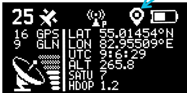
**Левая часть экрана** отображает количество видимых спутников, а также качество сигнала, эта информация валидна всегда при включенной функции определения координат.
