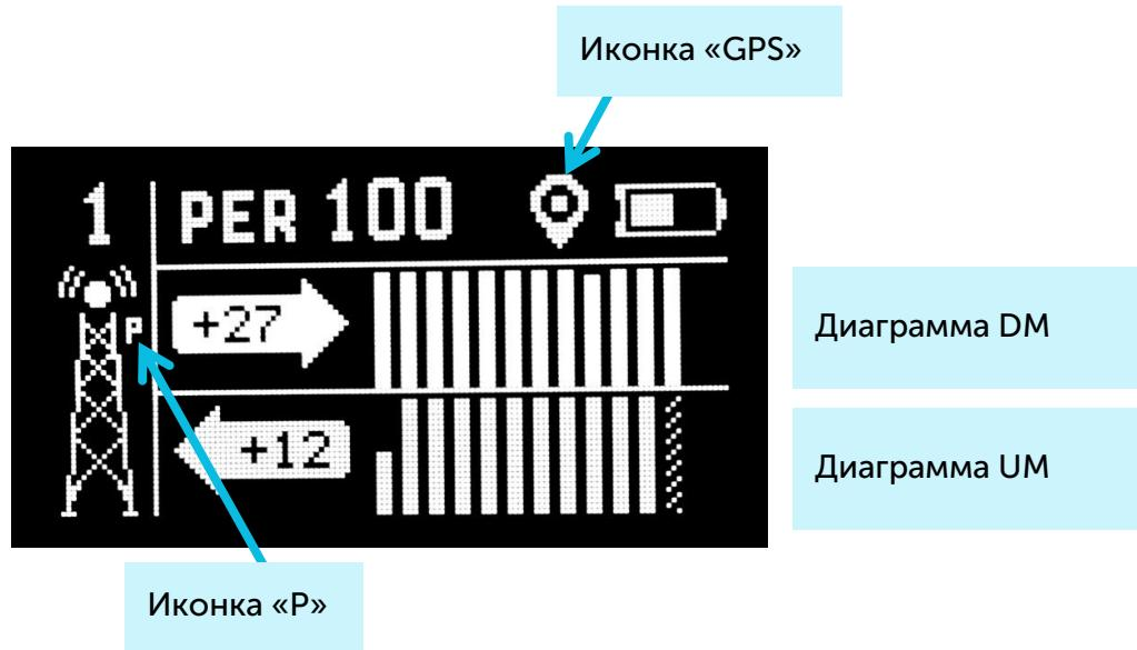
Диаграммы DM и UM - стрелка указывает направление распространения радиосигнала, а диаграмма отображает историю его изменения. Уровень каждого столбика диаграммы отображает запас демодуляции конкретного пакета. Самый последний (недавний) радиообмен отображается на столбике, расположенном рядом со стрелкой. На самой стрелке выводится численное значение запаса демодуляции в дБм самого последнего радиообмена. В процессе выполнения новых передач, диаграмма сдвигается вправо.
